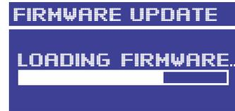
5. Une fois le firmware chargé dans la mémoire interne, le module d'amplification de l'enceinte l'écrit dans le stockage permanent. Cette étape ne prend que trois à quatre secondes, **N'interrompez pas ce processus.**
